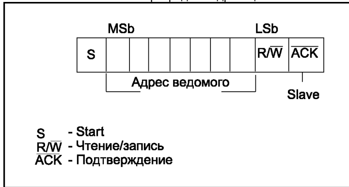
Рис. A-2 10-разрядная адресация
