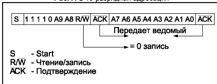
Рис. A-2 10-разрядная адресация
